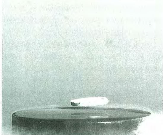
超伝導現象によるマイスナー効果。超伝導体を磁場の中に置いてやると、反磁性を帯び、そのため生じる反発力によって浮遊する
